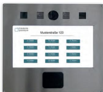
**Die moderne Video-Gegensprechanlage** – Der HausAdapter ist die digitale Außenstation der Video-Gegensprechanlage mit Zugangssystem. Das digitale Zugangssystem verringert für Hauseingangs- und Nebentüren Risiko und Kosten bei einem Schlüsselverlust.
